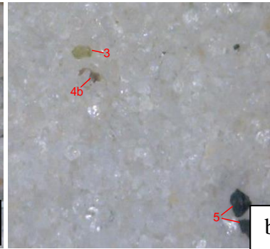
Perfil 3 – Horizonte A - (a) Areia grossa (b) Areia fina: 1a – feldspato branco; 1b – feldspato róseo; 2a – quartzo subarredondado avermelhado (óxido de ferro); 2b - quartzo muito anguloso a anguloso, hialino; 3 – biotita alterada; 4 – fragmentos orgânicos (a) semente e (b) tecido vegetal; 5 – minerais opacos.
