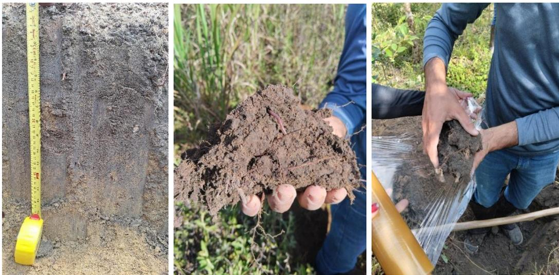
A= Perfil em Argissolo, com aproximadamente 50cm, aberto para coletas; B= amostra indeformada em formato de torrão; C= Agregados sendo envoltos em plástico filme para preservação da estrutura. Fonte: autor.
