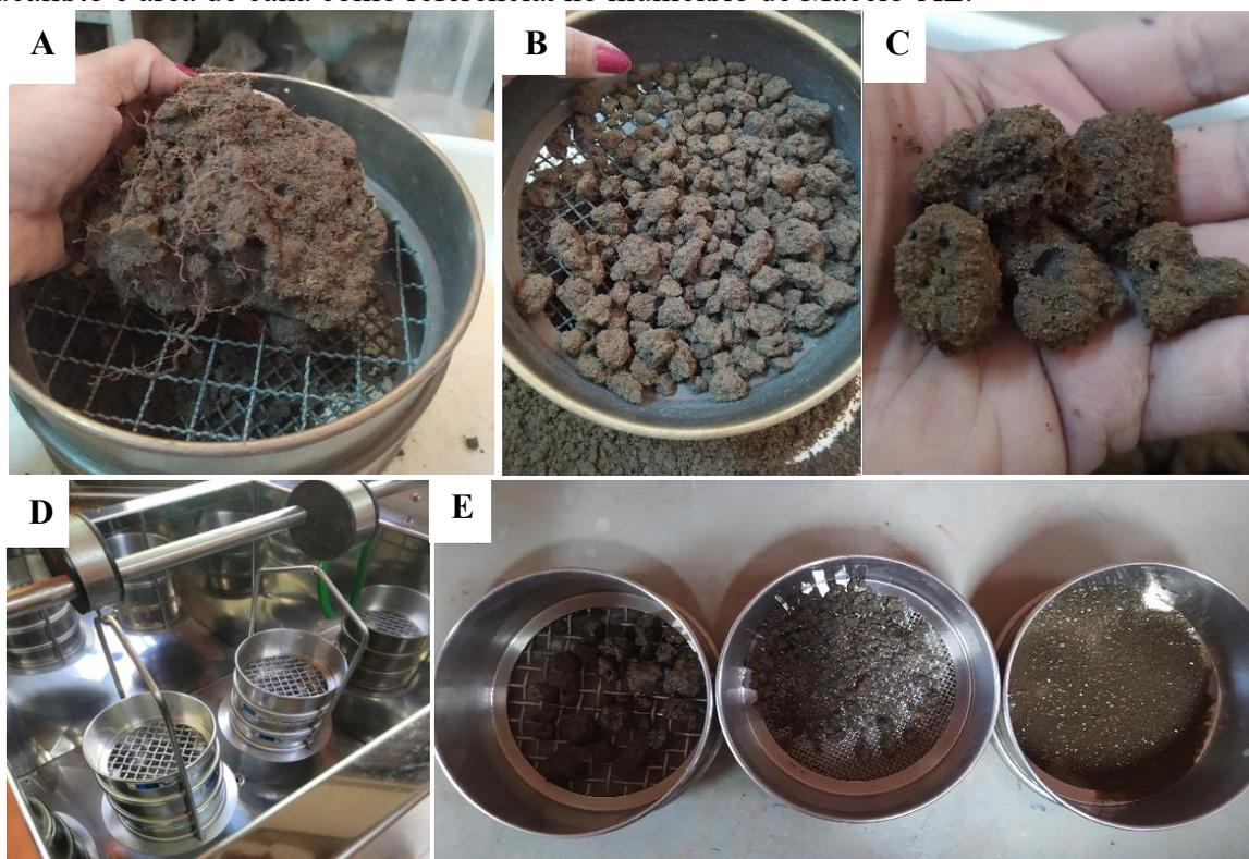
A= torrão sendo dividido em pontos de fraqueza; B= padronização do tamanho dos agregados, retidos em peneira de 7mm; C= agregados uniformes apresentando bioporos; D= oscilador horizontal utilizado na análise; E= detalhe das peneiras com macroagregados extragrandes, grandes e pequenos, retidos após oscilação por aproximadamente 15 min via úmida. Fonte: autor.
