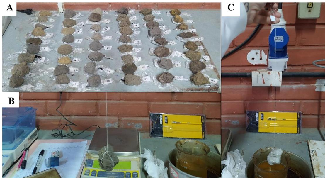
A= torrões entre 4 e 7 cm, prontos para imersão na parafina derretida; B= pesagem do conjunto torrão com fios e clips; C= revestimento do torrão na parafina derretida. Fonte: autor.
