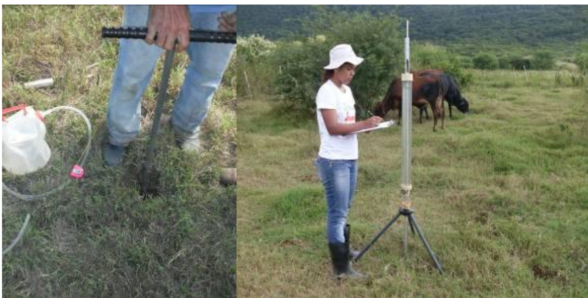
Figura 5. Preparo do furo para a realização do teste de condutividade hidráulica; avaliação da infiltrabilidade por meio do permeâmetro de Guelph.
