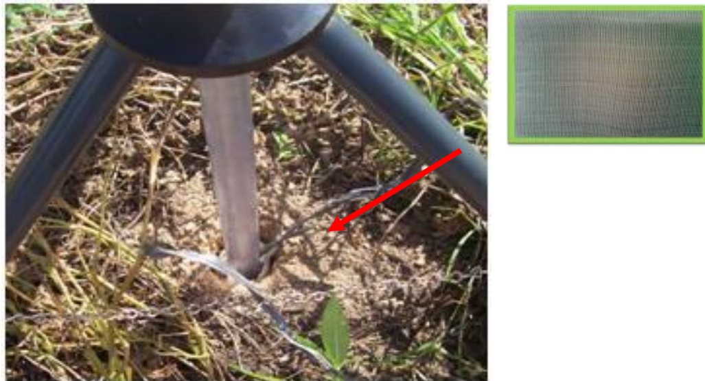
Figura 3. Detalhe do furo com a tela de proteção das paredes laterais durante a realização do ensaio; detalhe da tela utilizada.
