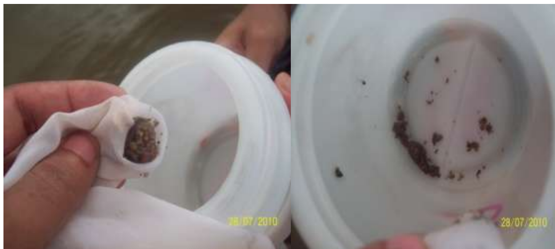
Figura 10 – Condicionamento e quantificação do sedimento de fundo coletado pelo amostrador BLH-84.
