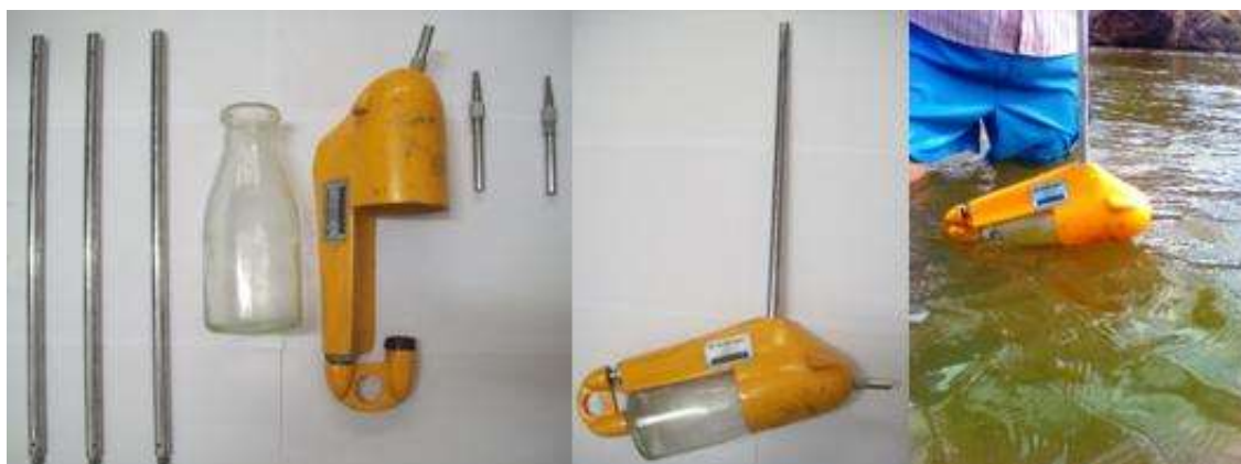
Figura 12 – Detalhamento do amostrador DH-48 e sua utilização a vau para a determinação da concentração de sedimento em suspensão ( C_{ss} ) com o uso do DH-48.
